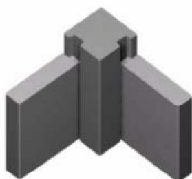
2 regatas descentradas alineadas a cara del pilar
